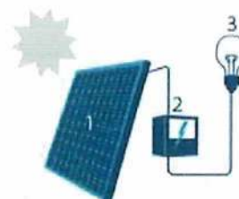
1. Zonnepaneel | 2. Omvormer | 3. Elektrische toestellen
