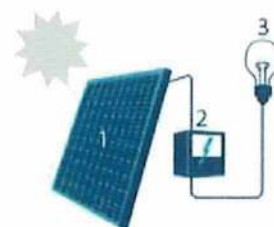
1. Zonnepaneel | 2. Omvormer | 3. Elektrische toestellen
